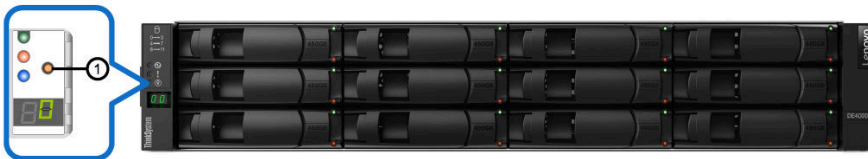
Figura 52. El botón ODP del estante de controladores y del estante de unidades con 12 unidades
