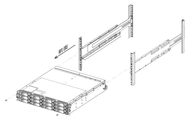
ステップ 6. エンクロージャーのブラケットおよびレール・キット・ブラケットに 2 本の M5 ねじを挿入することによって、レール背面にエンクロージャーを固定します。
