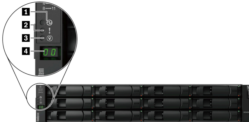
Figura 50. LEDs no painel de exibição do operador
