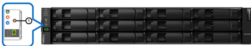
Figura 52. Botão de comando ODP na prateleira do controlador e na prateleira da unidade com 12 unidades
