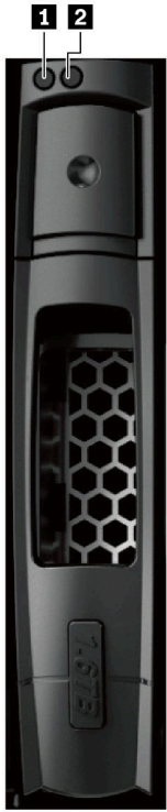
图 55. 2.5 英寸驱动器上的 LED
