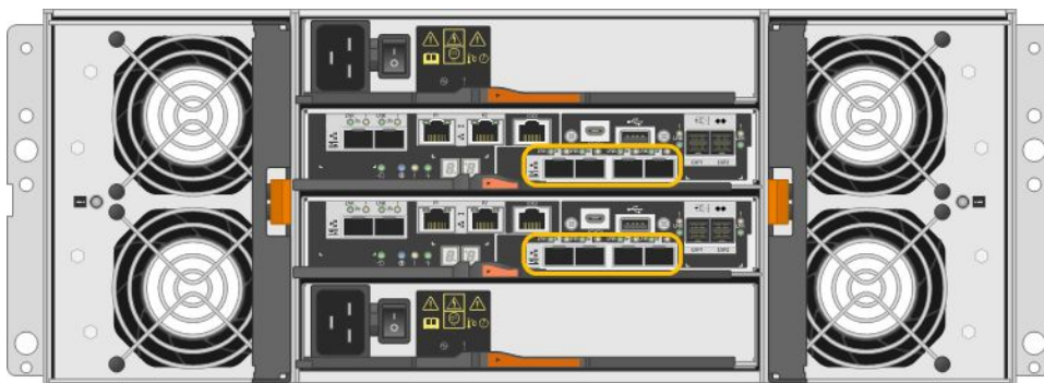
図29. 2つの4ポート SFP+ (光学式) HIC 搭載 (4U)
