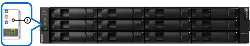
図 52. コントローラー・シェルフ、および 12 個のドライブがあるドライブ・シェルフの ODP プッシュ・ボタン
