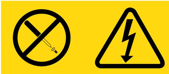
任何贴有此标签的组件内都有危险的电压、电流和能量级别。这些组件内部没有可维护的部件。如果您怀疑某个部件有问题，请联系技术服务人员。
