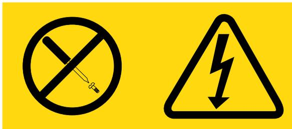
任何贴有该标签的组件内部都存在危险的电压、电流和能量级别。这些组件内部没有可维护的部件。如果您怀疑某个部件有问题，请联系技术服务人员。
