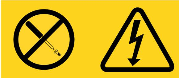
In Komponenten, die dieses Etikett aufweisen, treten gefährliche Spannungen und Energien auf. Diese Komponenten enthalten keine Teile, die gewartet werden müssen. Besteht der Verdacht eines Fehlers an einem dieser Teile, ist ein Kundendiensttechniker zu verständigen.
