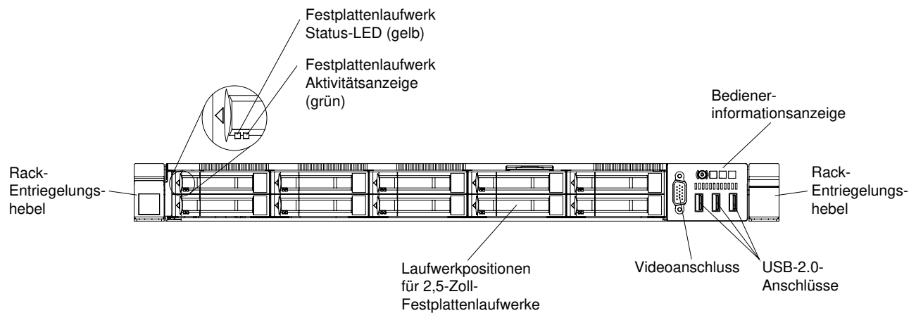
Abbildung 14. Vorderansicht: Servermodell mit zehn 2,5-Zoll-Hot-Swap-Laufwerken
