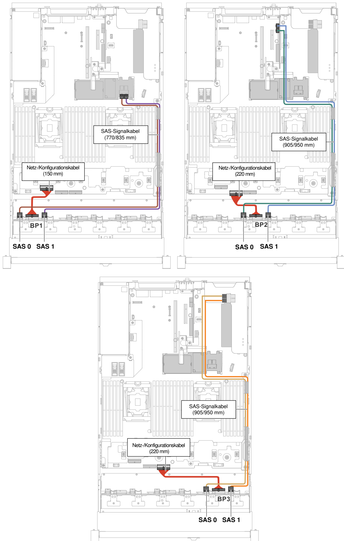
Abbildung 61. 24 x 2,5-Zoll-Hot-Swap-Festplattenlaufwerkverkabelung 158 Installations- und Servicehandbuch zu Lenovo System x3650 M5
