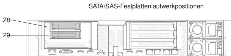
Abbildung 141. Nummerierung für einen Bausatz für zwei 2,5 Zoll-Festplattenlaufwerke an der Rückseite
