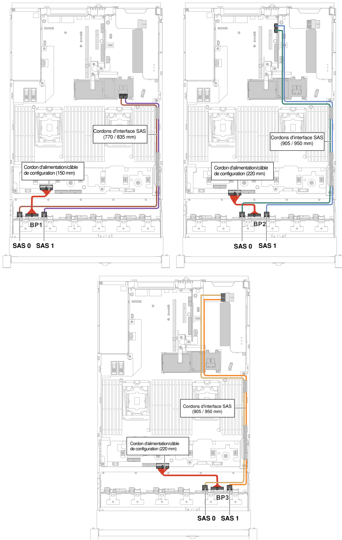
Figure 61. Câblage d'une unité de disque dur 24 x 2,5 pouces remplaçable à chaud 154 Lenovo System x3650 M5 Guide d'installation et de maintenance
