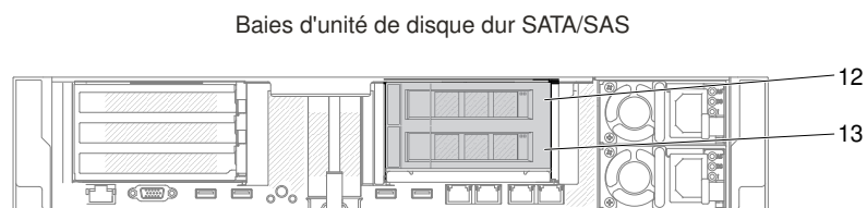
Figure 143. Numérotation d'un jeu arrière de deux unités de disque dur 3,5 pouces (avec ou sans carte RAID)
