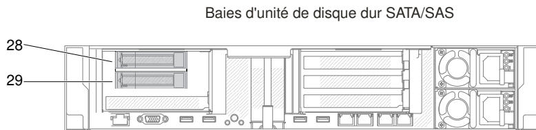
Figure 139. Numérotation d'un jeu arrière de deux unités de disque dur 2,5 pouces
