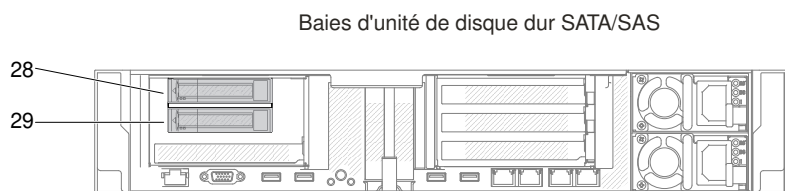
Figure 141. Numérotation d'un jeu arrière de deux unités de disque dur 2,5 pouces
