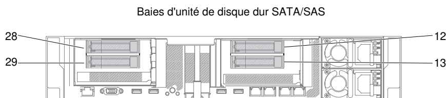
Figure 142. Numérotation de deux jeux arrières de deux unités de disque dur 2,5 pouces
