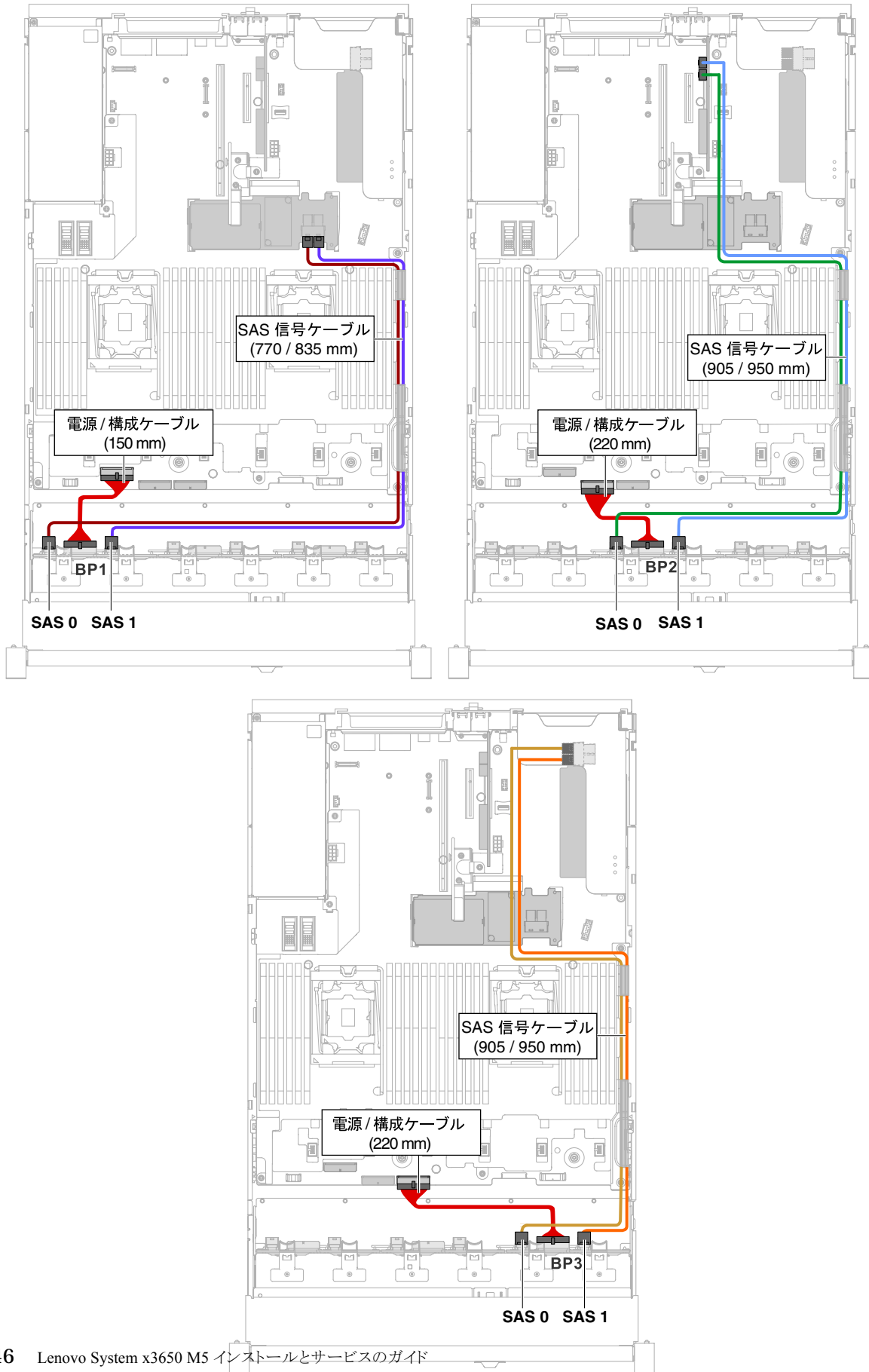
図 61. 24x2.5 型ホット・スワップ・ハードディスク・ドライブのケーブル接続
