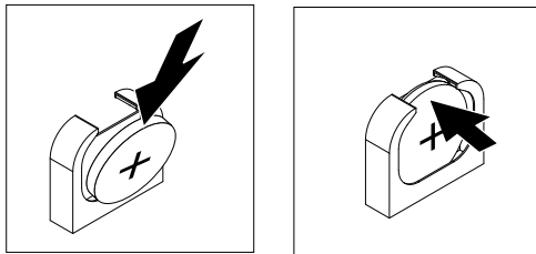
그림 208. 시스템 배터리 설치
