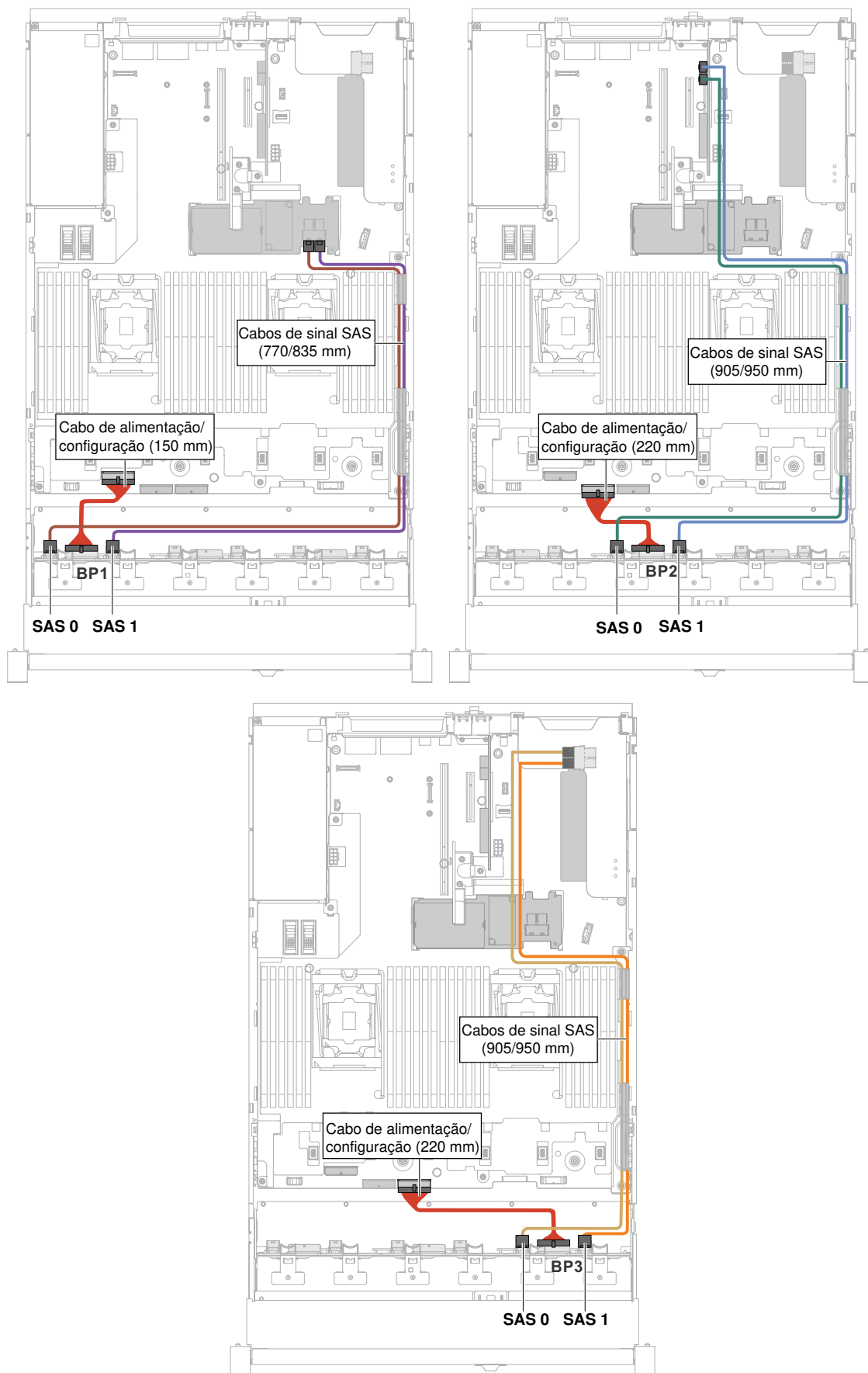
Figura 274. Roteamento de cabo
