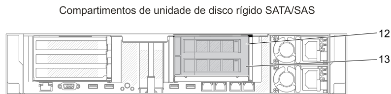
Figura 143. Numeração do kit de uma unidades de disco rígido traseiras de 3,5 pol. (com ou sem placa RAID)
