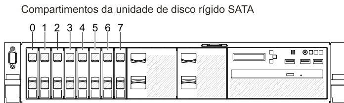
Figura 1. Vista frontal do modelo simple-swap de 2,5 polegadas
