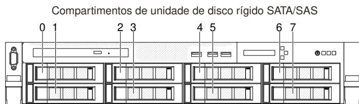
Figura 6. Vista frontal do modelo hot swap de 3,5 polegadas
