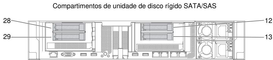
Figura 142. Numeração dos kits de duas unidades de disco rígido traseiras de 2,5 pol.
