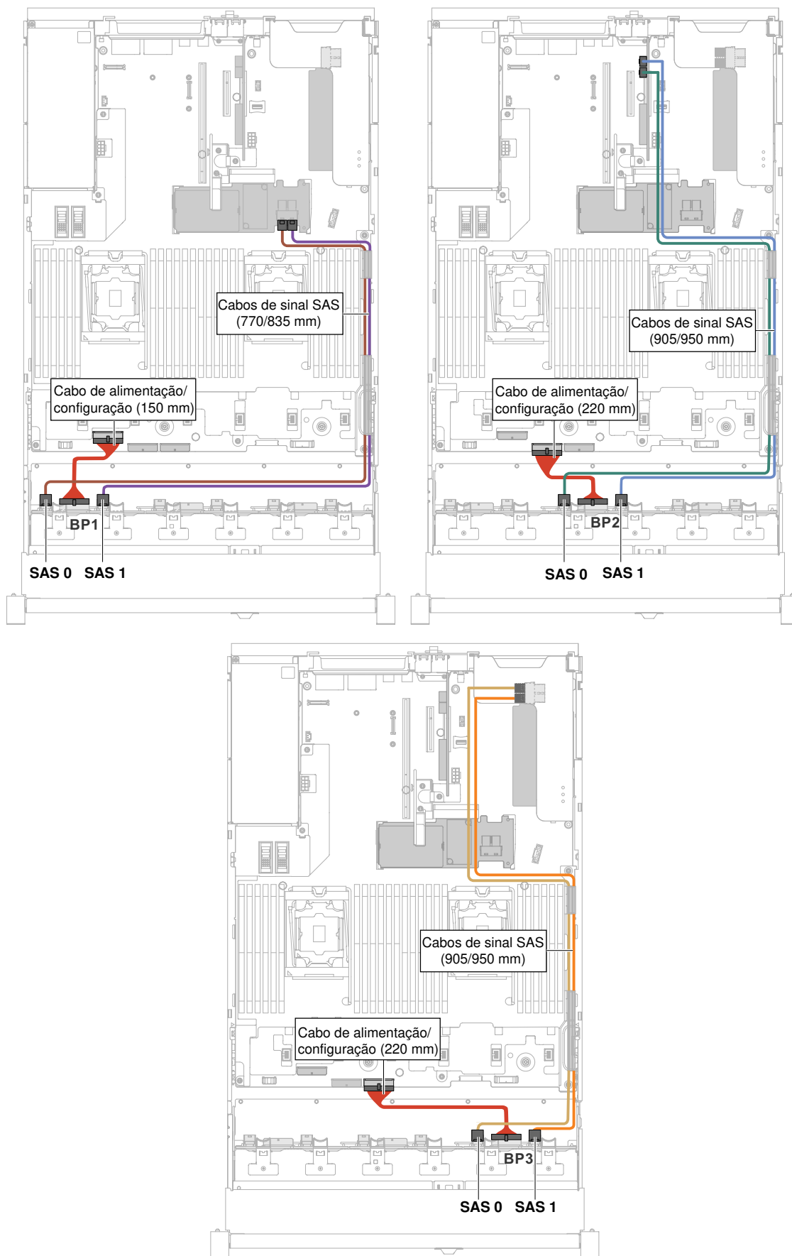
150 Figura 61. Cabearamento das 24 unidades de disco rígido hot swap de 2,5 polegadas Lenovo System x3650 M5 Guia de Instalação e Serviço
