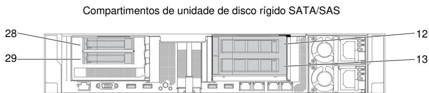
Figura 144. Numeração dos kits de uma unidade de disco rígido de 3,5 pol. e uma de 2,5 pol.
