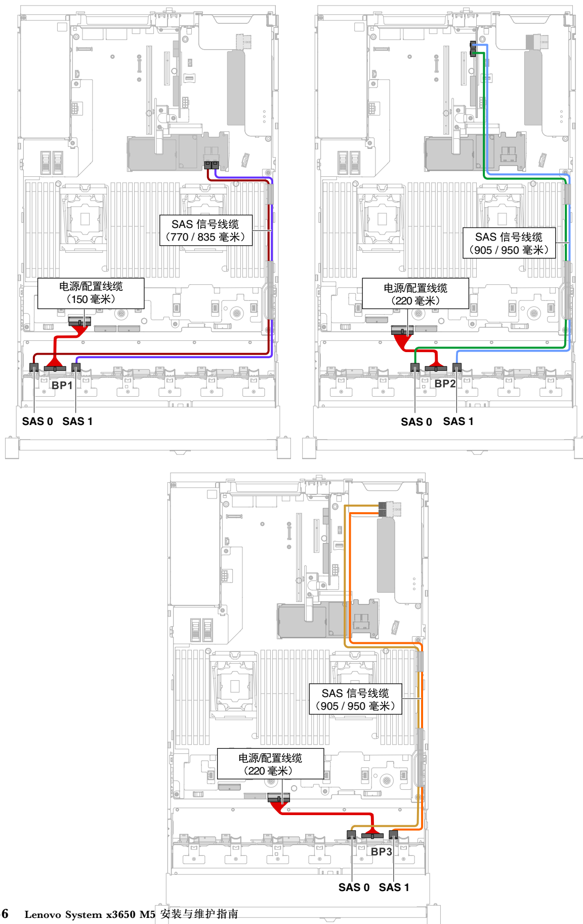
图 61. 24x2.5 英寸热插拔硬盘线缆连接
