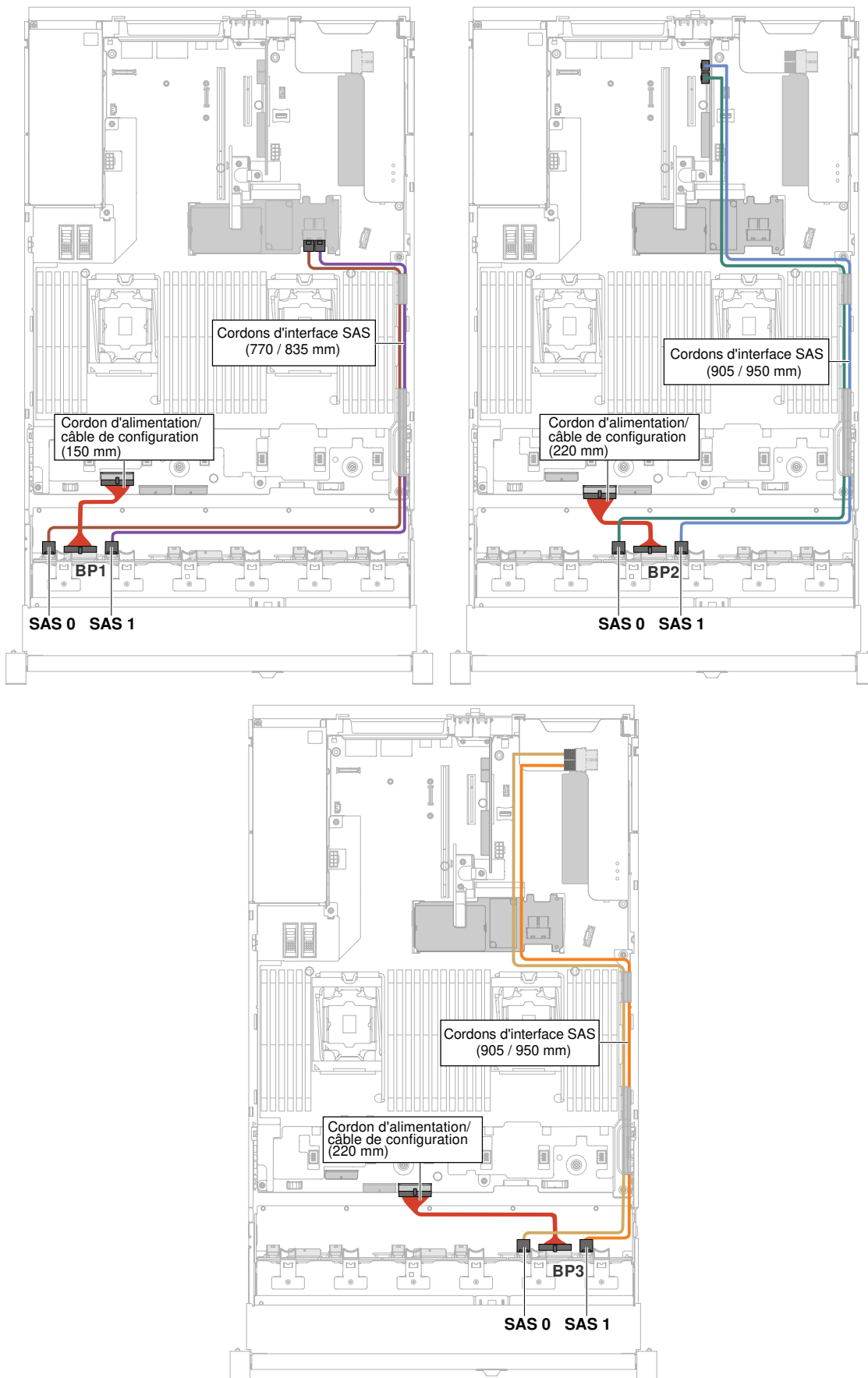
Figure 68. Câblage d'une unité de disque dur 24 x 2,5 pouces remplaçable à chaud
