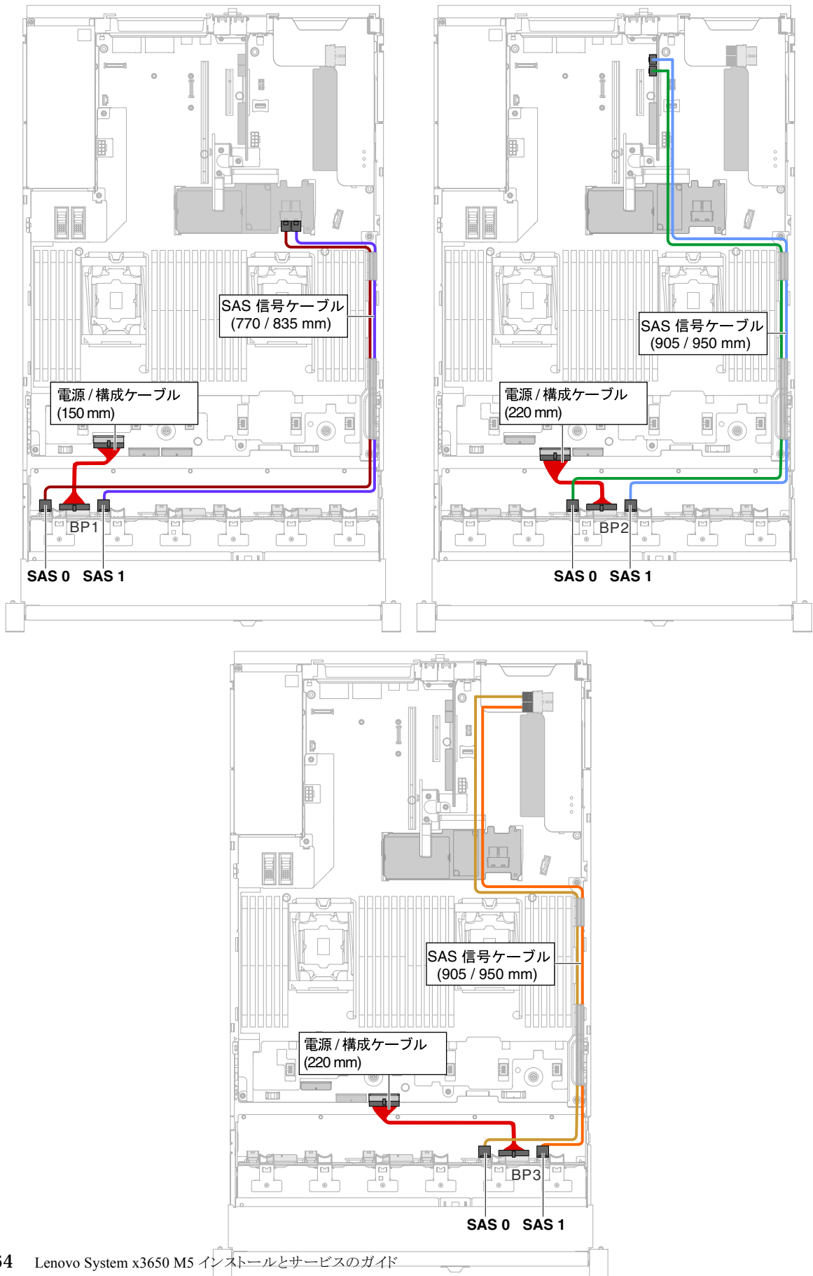
図 68. 24x2.5 型ホット・スワップ・ハードディスク・ドライブのケーブル接続
