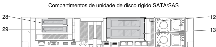
Figura 151. Numeração dos kits de uma unidade de disco rígido de 3,5 pol. e uma de 2,5 pol.
