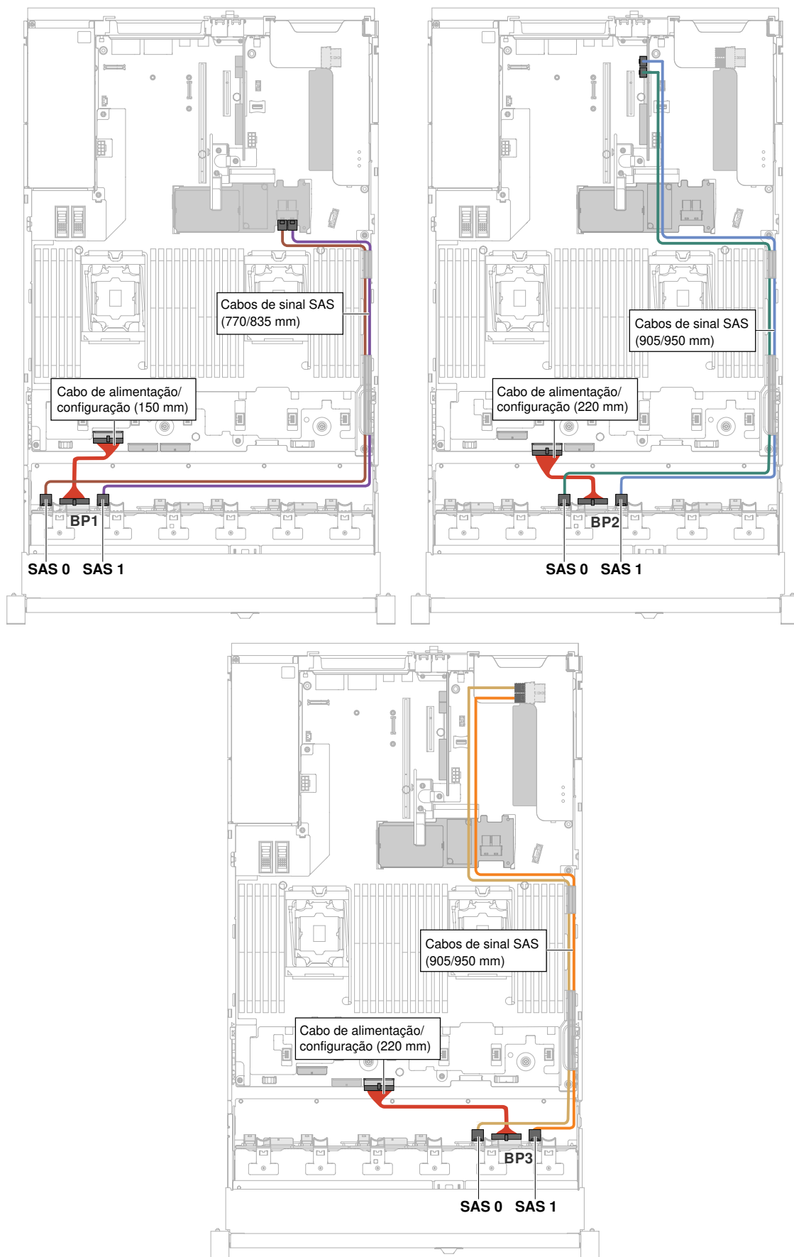
Figura 281. Roteamento de cabo
