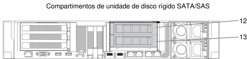
Figura 150. Numeração do kit de uma unidades de disco rígido traseiras de 3,5 pol. (com ou sem placa RAID)
