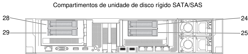
Figura 148. Numeração dos kits de duas unidades de disco rígido traseiras de 2,5 pol.
