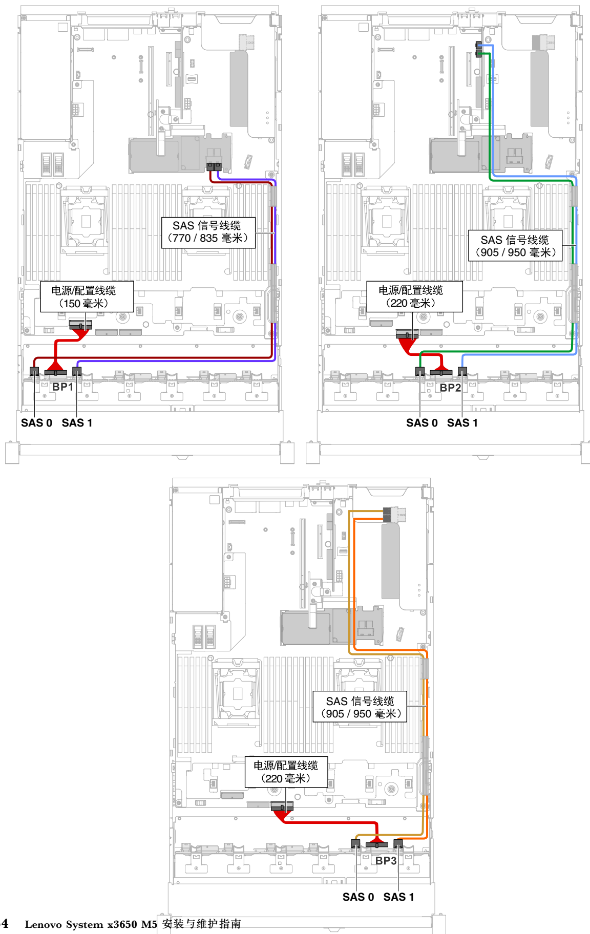
图 68. 24x2.5 英寸热插拔硬盘线缆连接
