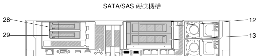
圖例 151. 一個 3.5 吋背面雙硬碟套件及一個 2.5 吋背面雙硬碟套件編號
