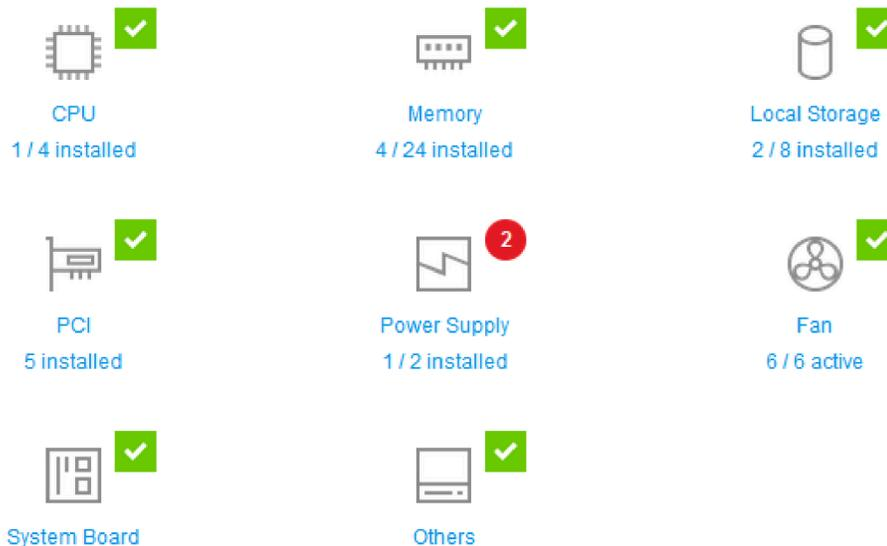
Если какой-либо из аппаратных компонентов не функционирует нормально, он будет помечен значком критической ошибки или предупреждения. Критическое состояние обозначается значком в виде красного круга, а предупреждение — желтым треугольником. Наводя указатель мыши на такой значок, можно просмотреть до трех активных в настоящее время событий для этого компонента.
